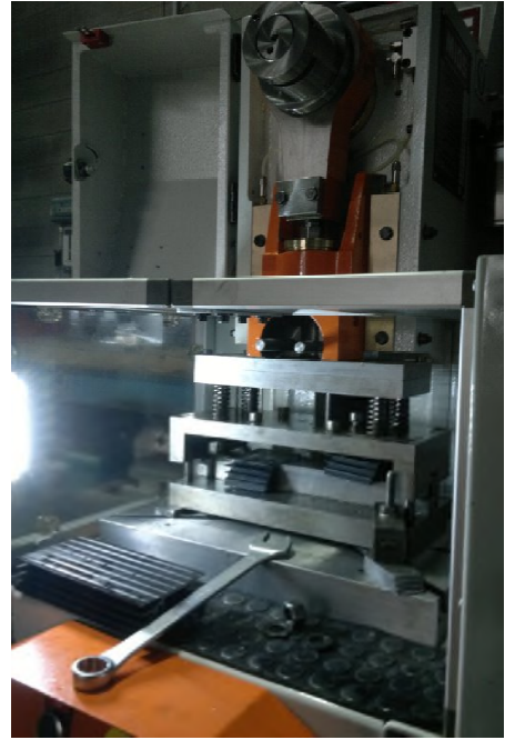
FOTOS DE EJEMPLO: SE EJECUTAN OPERACIONES DE BLANCO EN PERFILES DE ALUMINIO EXTRUIDO
