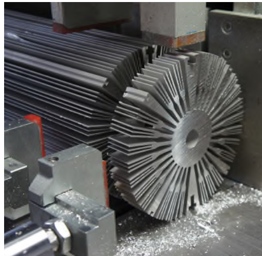
FOTO DE EJEMPLO: CORTE DE DISIPADORES DE CALOR A MEDIDA "FLOR" AUNQUE DE GRANDES DIMENSIONES
