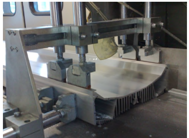
FOTO DE EJEMPLO: CORTE DE PERFIL DE ALUMINIO EXTRUIDO PARA LED GRANDES
